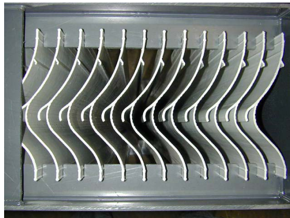
Foto n° 2: Particolare batterie alettate di separazione
