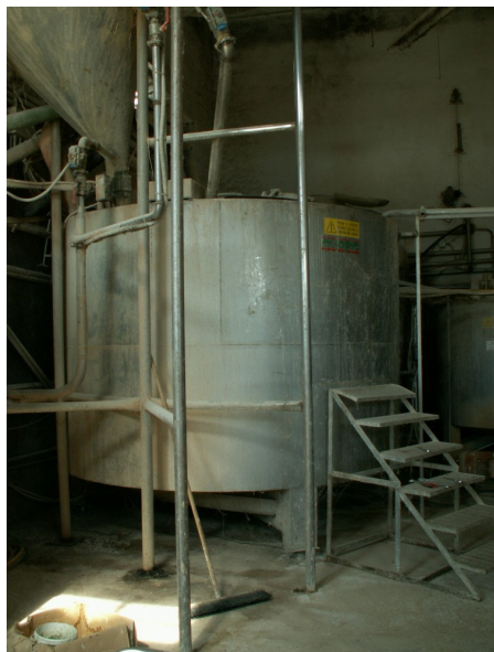
Foto 06 e 07: impianto di miscelazione cereali con importazione da silos e preparazione "ricette".
