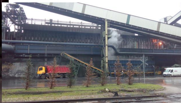
Foto 4. Fase di carico del coke dal cassone metallico d'emergenza sugli automezzi.
