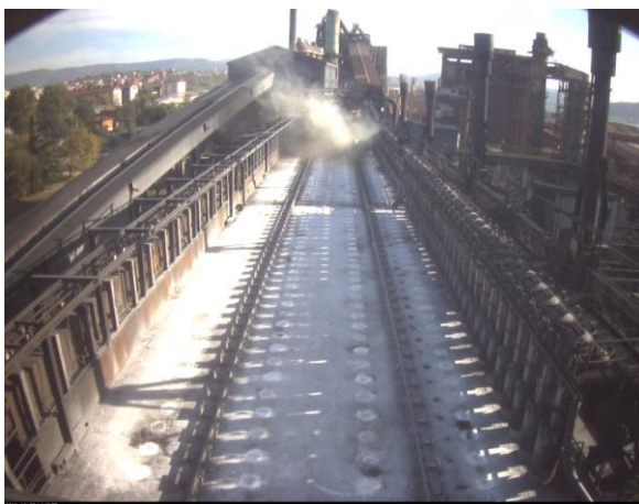
Foto 5. Ore 14:46 del 29/10/2016 – Fumo con elevata quantità di vapore che fuoriesce da un forno isolato pronto per lo sfornamento.
