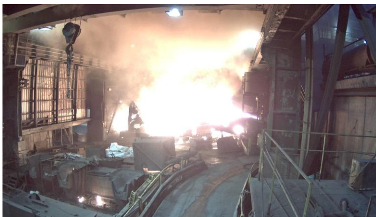
Foto 11. Sequenza con diversi fotogrammi a partire dall'inizio dell'evento anomalo fino alla fase di culmine ripresa dalla telecamera all'interno del piano di colata.
