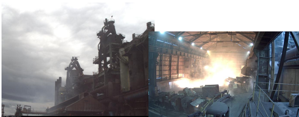
Foto 8. Ore 16:18 del 06/11/2016 - Altoforno - colata anomala con grande generazione di fumosità al di fuori dell'edificio piano di colata.
