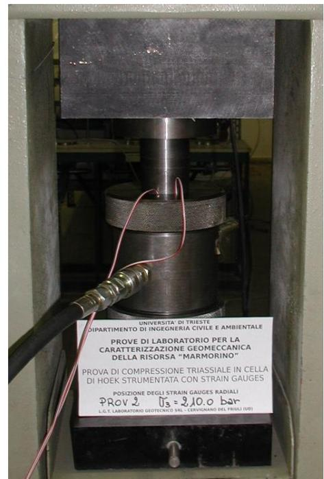
Figura 15. Prova di compressione triassiale su roccia: provino 2
