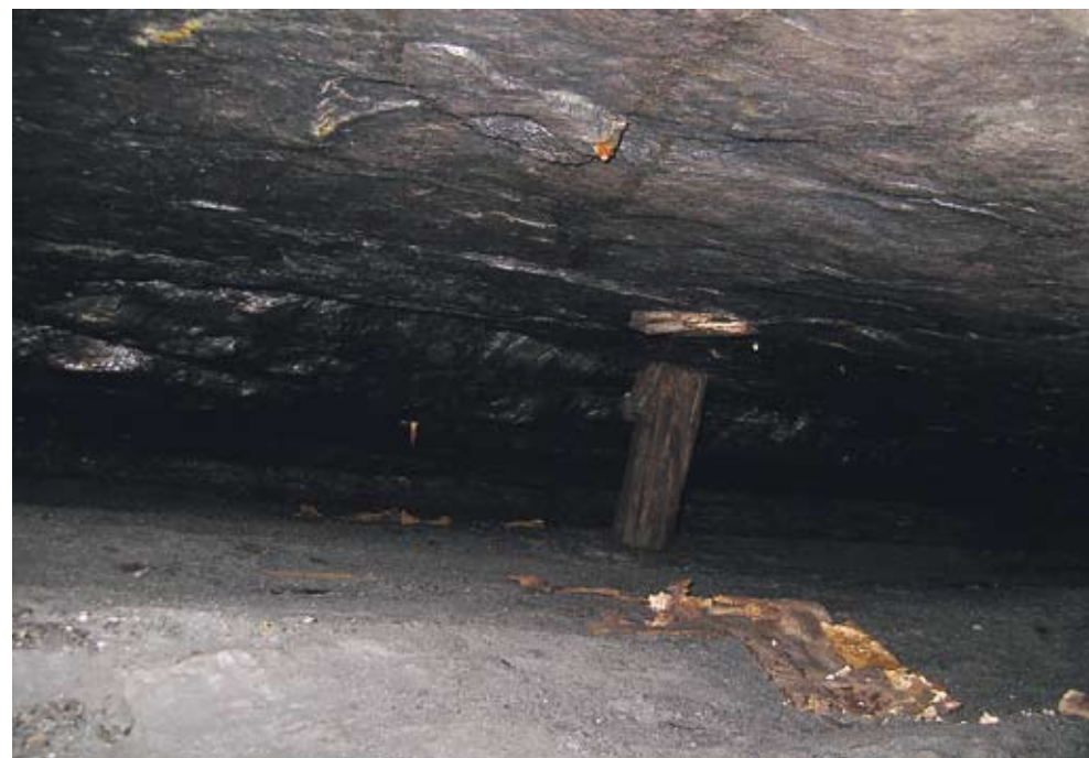
Lo sfruttamento del carbone prevedeva di seguire i livelli mineralizzati che spesso avevano uno spessore piuttosto limitato e, così, alcuni tratti di galleria sono alti meno di un metro.
